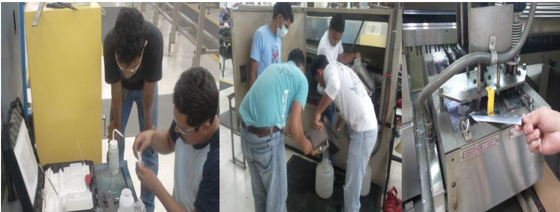
Figura 5: Control del nivel de estaño.
