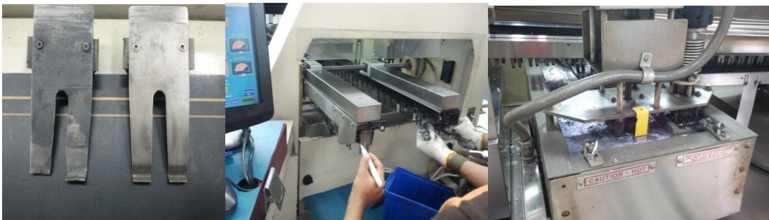
Figura 3: Proceso del baño de soldadura.
