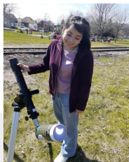
Fig. 4 telescopio refractor 60mm para observación indirecta
